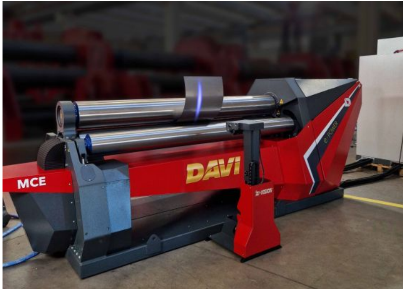
Das Lasermesssystem AI-Vision scannt während des Biegens einen breiten Bereich der Blechoberfläche
