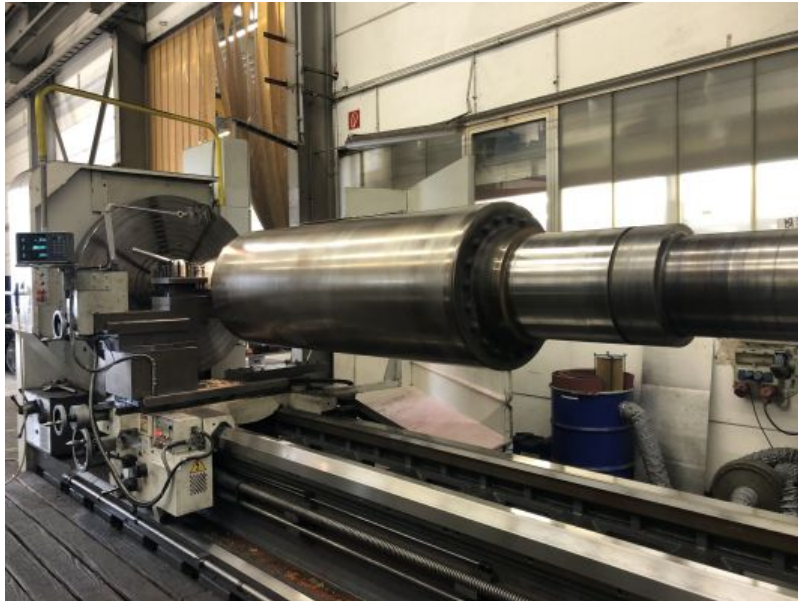
Fertigbearbeitung der aufgearbeiteten Walze
