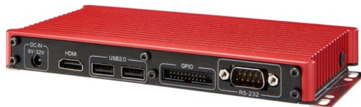
SmartSL U7-130, der kleinste lüfterlose IPC von EFCO, verfügt über 16 digitale IOs
