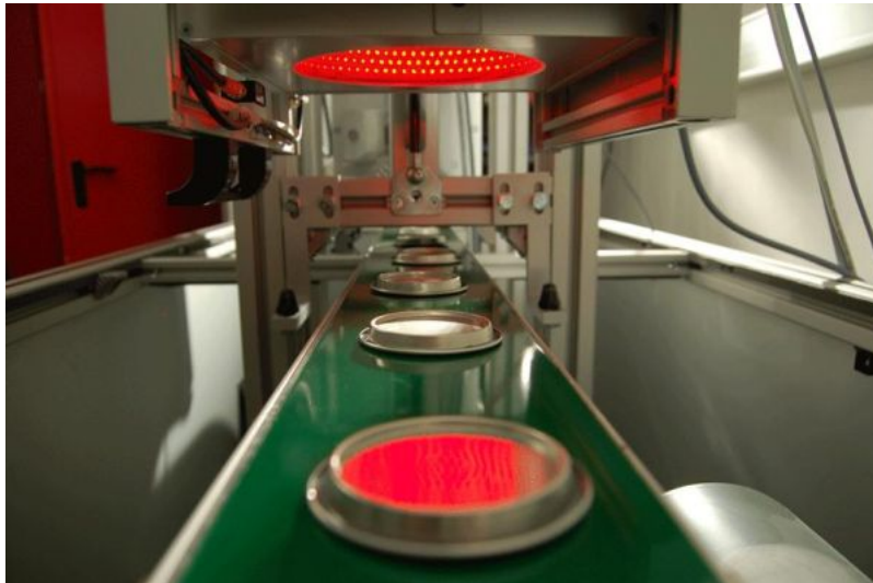
TCVision.I ? Die ?Money-making machine? auf dem Gebiet der Inspektion von Shells und Lined Shells.
