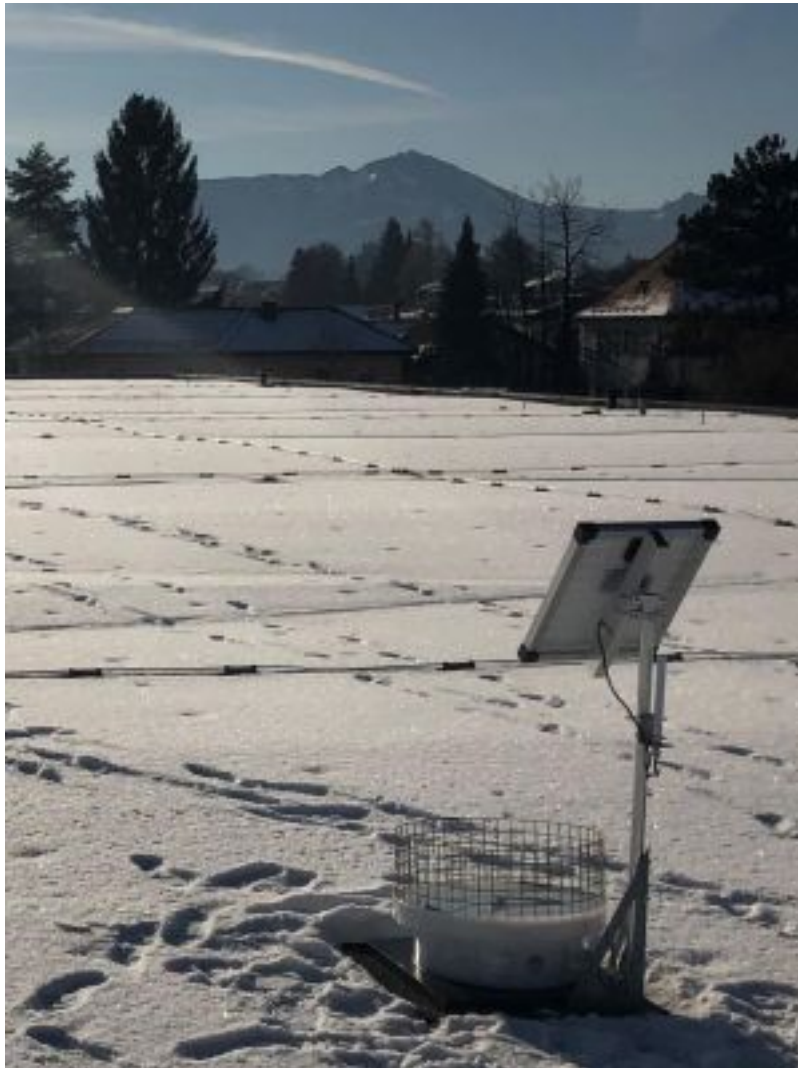
snowcontrol Schneewaage von Envitron
