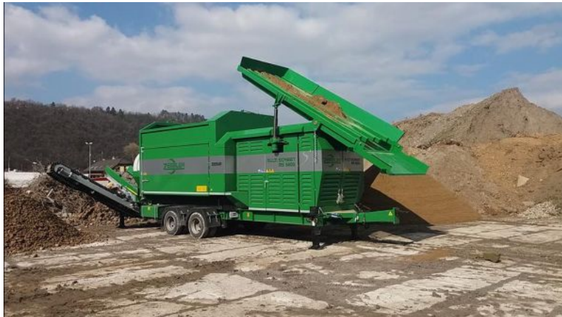
Mobile Doppeltrommel-Siebanlage MS5200 mit Steingitter zur Überkornabscheidung
