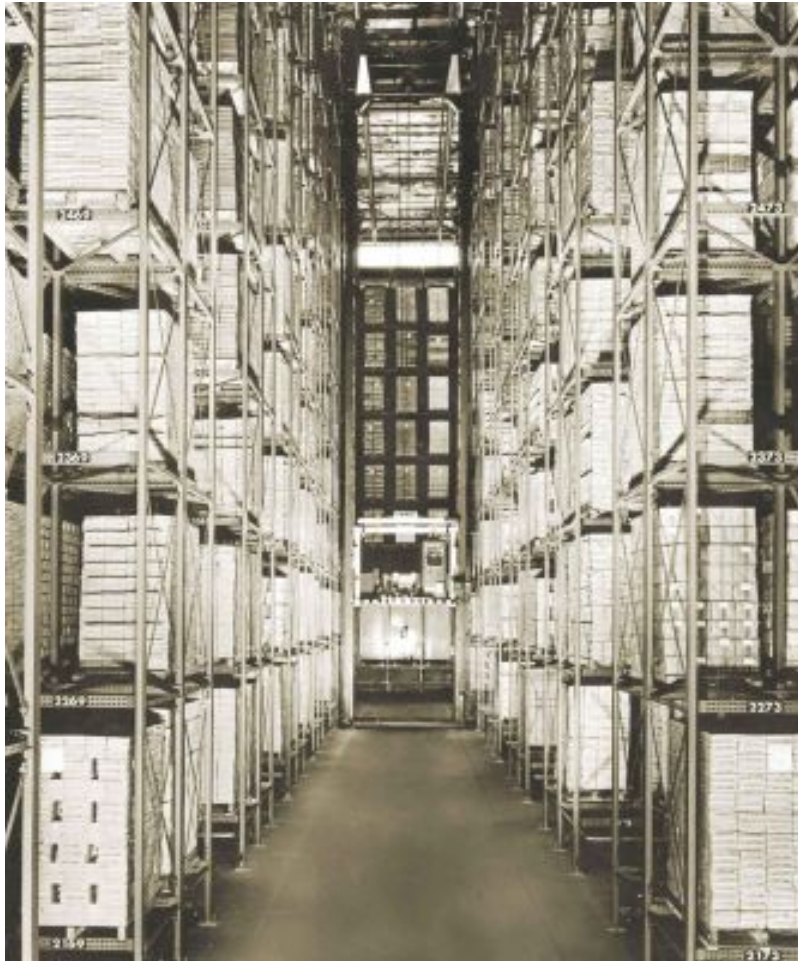
Das erste automatische Regalbediengerät installierte Demag bei Bertelsmann. (Foto: Dematic)
