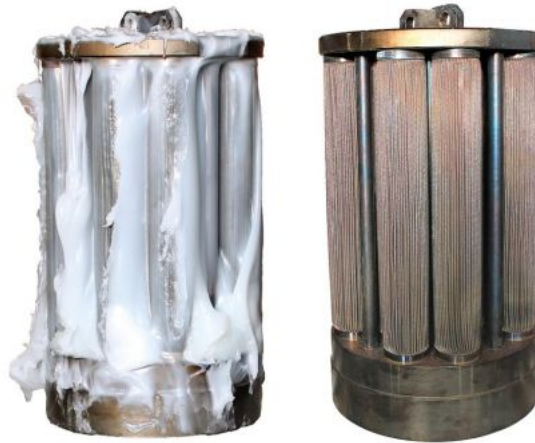
SCHWING Technologies: Filterbündel vor und nach der thermischen Reinigung
