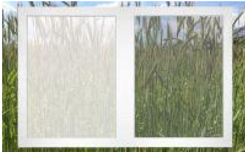
links herkömmliches, rechts neuestes Pollenschutz-Gewebe
