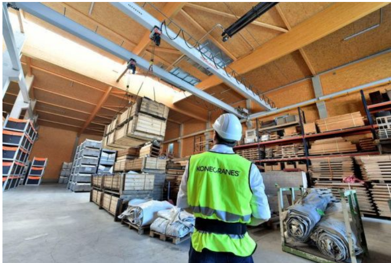
Der neue Zweiträger-Brückenkran mit Elektrokettenzügen von Konecranes
