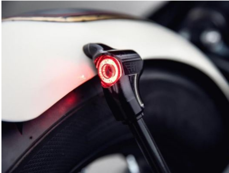
Motorrad-Kotflügel-Streben mit integrierten LED-Blinker, Rück- und Bremslicht
