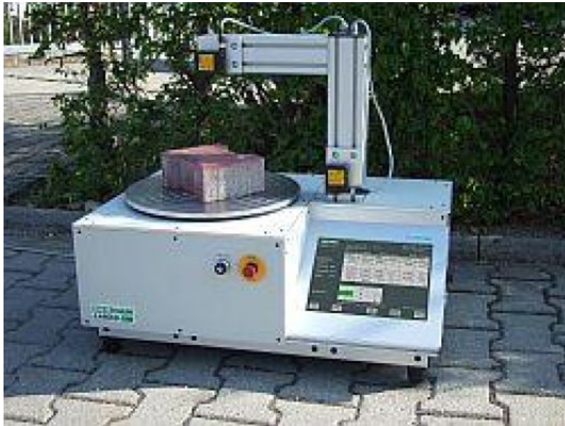
Laser- Mess- und Analyse-System LAMAS 21W zur Bestimmung der Rohdichte von Betonsteinen.
