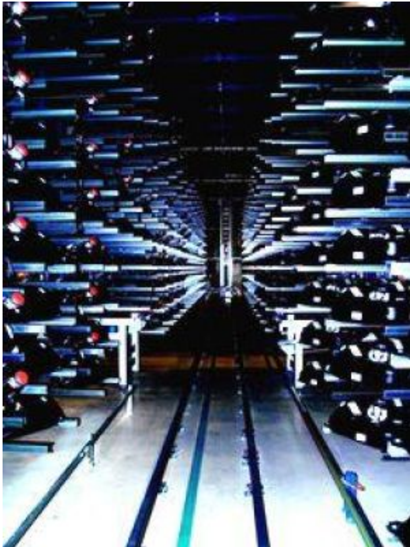
Behälterloses lagern von Tanks für die Mercedes C-Klasse im AKL bei TI Automotive in Bremen
