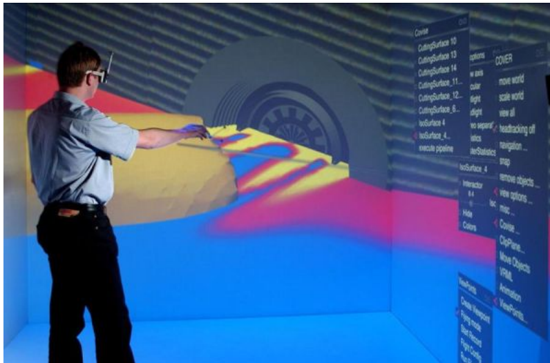
3D-Visualisierung von einer Feuerraumsimulation. Quelle: Eye-Scream Fotostudio, Hansjörg Riedel
